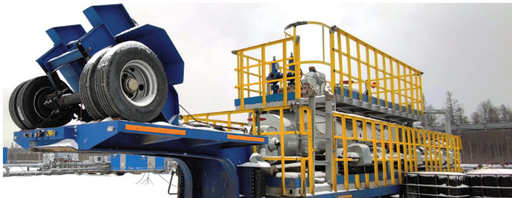
ПКИОС на Чаяндинском нефтегазоконденсатном месторождении – это своего рода мобильная миниатюрная установка предварительной подготовки газа
